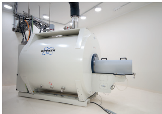
9,4 Tesla-Kleintiermagnetograph. Foto: Tilch
